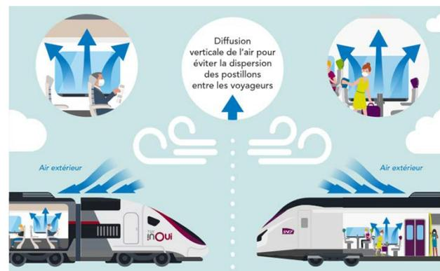
Figura 1: Figura da SNCF demonstrando como o ar circula em seus sistemas de ventilação a bordo do TGV e em outros trens
